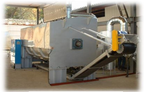
生ゴミ乾燥機熱源利用
