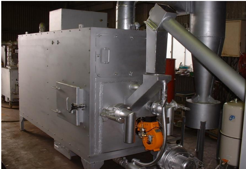
バイオマスエコボイラー
